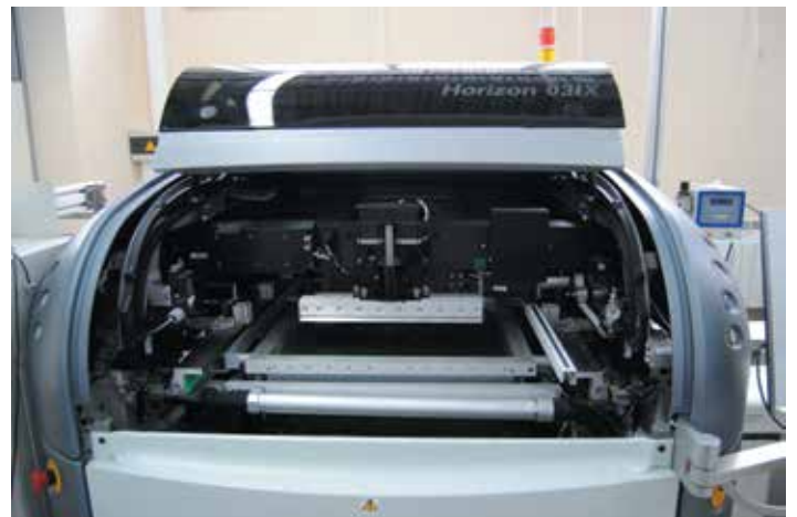
Установка трафаретной печати Horizon 03iX с системой Hawkeye и очисткой трафарета снизу
