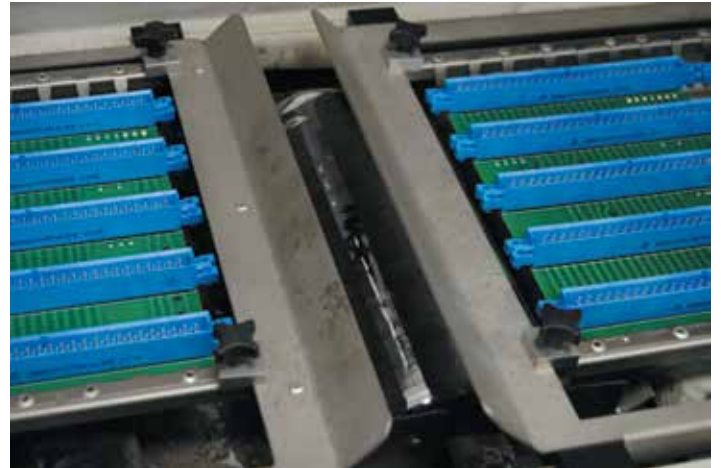
Процесс пайки волной припоя разъемов на коммутационной панели
