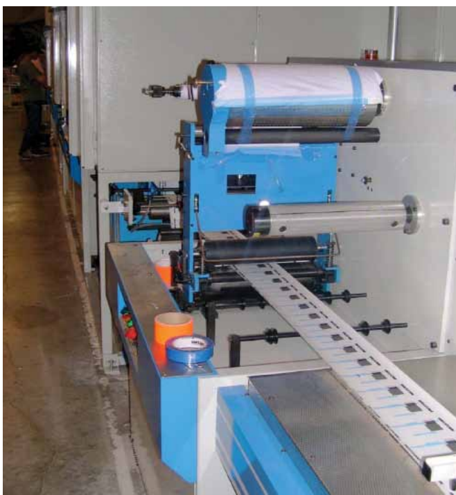
Рис. 4 Рулонная печать батареек. Источник Blue Spark
