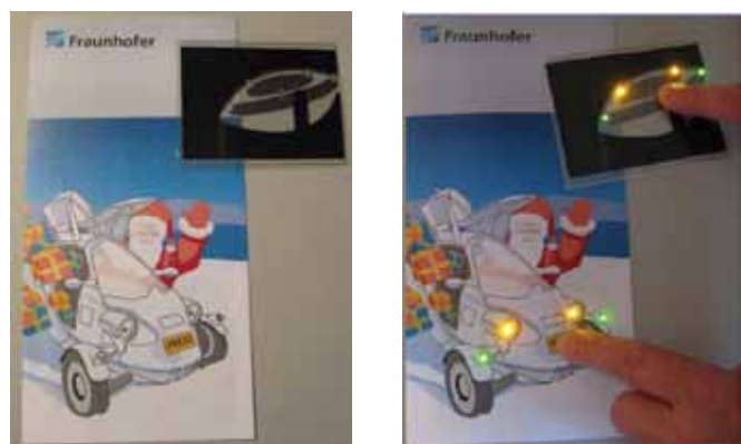
Рис. 9 Интерактивная открытка, в которой гибкая печатная батарейка используется для питания светодиодов. Источник: Fraunhofer ENAS
