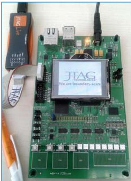
Рис. 1. Внешний вид демоплаты JT 2156 и контроллера JTAG Live USB
