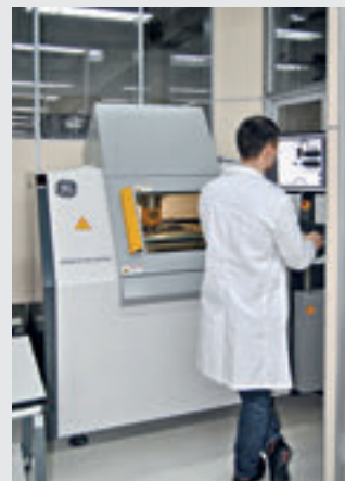
Контроль качества изготовления печатных узлов: API Phoenix Microtelx DXR-HD, АОИ Viscom s3088 Ultra blue
