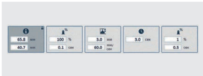
8 Программирование параметров процесса для отдельных участков платы
