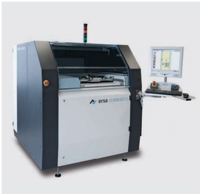
1 Пример современной установки селективной пайки для мелкосерийного производства
