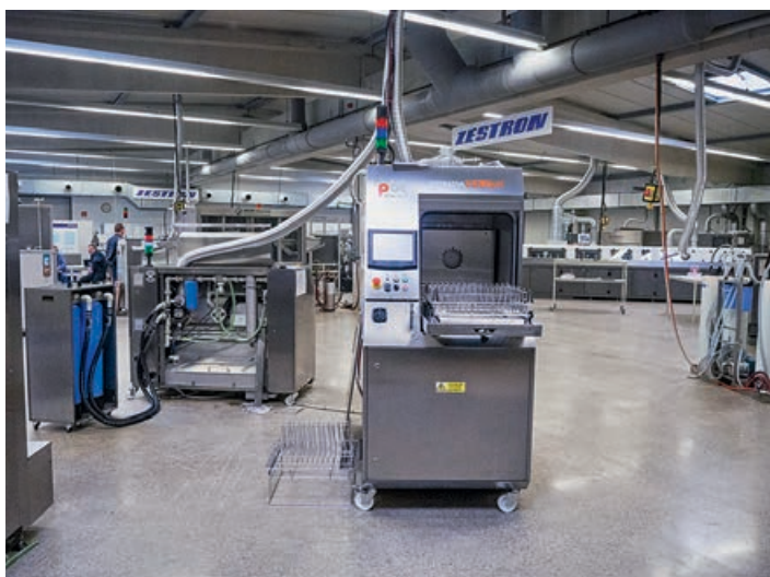
Установки отмытки различных производителей в техническом центре Zestron
