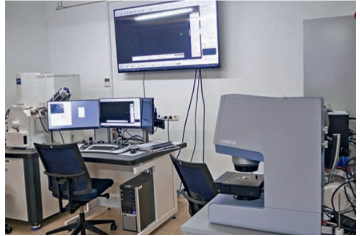
Сканирующий электронный микроскоп (слева) и ИК-Фурье-микроскоп (справа)
