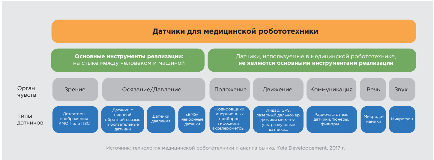
1 Две группы датчиков в медицинской робототехнике
