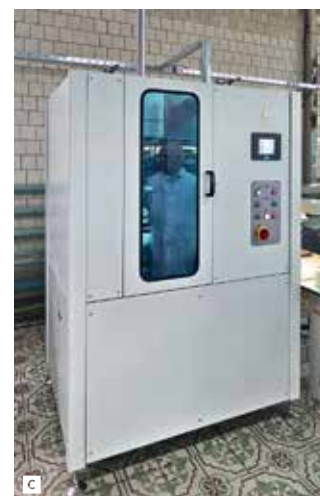
Последние операции перед разделением групповой заготовки: А – рабочее место комплектования пакета карт (идет сборка пакета сдвоенной заготовки корпусов с глубоким колодцем для ФПЗС); В – упаковка пакета карт в герметичную оболочку с откачкой из нее воздуха; С – изостатический пресс КЕКО ILS-66, в котором производится ламинирование (замоноличивание) пакета
