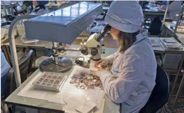
На выходном контроле проверяется 100 % изготовленных оснований корпусов: визуальный контроль (слева); полуавтомат контроля герметичности с гелиевым течеискателем (справа)
