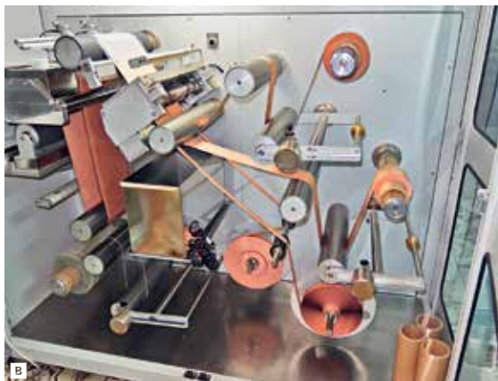
Оборудование для литья керамической ленты компании КЕКО: A – линия САМ-Н; B – выходной модуль линии, в котором осуществляется контроль толщины ленты и резка ее на полосы заданной ширины; в левом верхнем углу на горизонтальной направляющей видны два маркера, отмечающие участки ленты, выходящие за пределы допуска; C – укладчик керамических листов SC-25MFPT; D – карты из сырой керамики, изготовленные на оборудовании КЕКО
