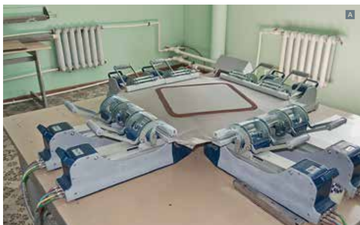
Работа установки РМ-8S: A – манипулятор захватывает карту; B – карта на центровочном столике; C – рама носителя надвинута на отцентрованную карту; D – карта в позиции пробивки – под пуансонами; E – карта с пробитыми колодцами в приемной cassette
