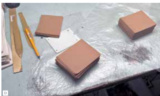
Оборудование для литья керамической ленты компании КЕКО: A – линия САМ-Н; B – выходной модуль линии, в котором осуществляется контроль толщины ленты и резка ее на полосы заданной ширины; в левом верхнем углу на горизонтальной направляющей видны два маркера, отмечающие участки ленты, выходящие за пределы допуска; C – укладчик керамических листов SC-25MFPT; D – карты из сырой керамики, изготовленные на оборудовании КЕКО
