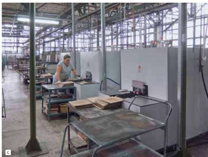
Пайка: A — графитовая групповая оснастка для сборки комплекта основания корпуса перед пайкой; B — сборка деталей корпуса в оснастке; C — конвейерные печи с водородной средой; D — готовый продукт: основание корпуса микросхемы
