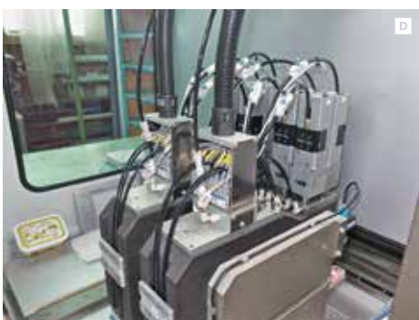
Работа установки РМ-8S: A – манипулятор захватывает карту; B – карта на центровочном столике; C – рама носителя надвинута на отцентрованную карту; D – карта в позиции пробивки – под пуансонами; E – карта с пробитыми колодцами в приемной cassette
