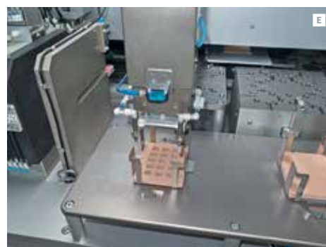
Работа установки РМ-8S: A – манипулятор захватывает карту; B – карта на центровочном столике; C – рама носителя надвинута на отцентрованную карту; D – карта в позиции пробивки – под пуансонами; E – карта с пробитыми колодцами в приемной cassette
