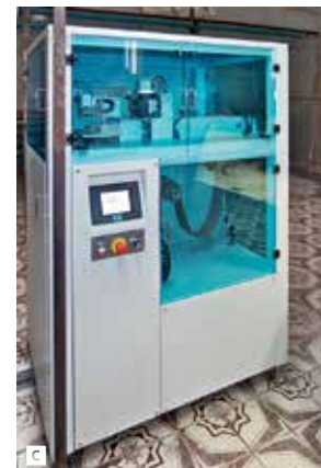
Оборудование для литья керамической ленты компании КЕКО: A – линия САМ-Н; B – выходной модуль линии, в котором осуществляется контроль толщины ленты и резка ее на полосы заданной ширины; в левом верхнем углу на горизонтальной направляющей видны два маркера, отмечающие участки ленты, выходящие за пределы допуска; C – укладчик керамических листов SC-25MFPT; D – карты из сырой керамики, изготовленные на оборудовании КЕКО
