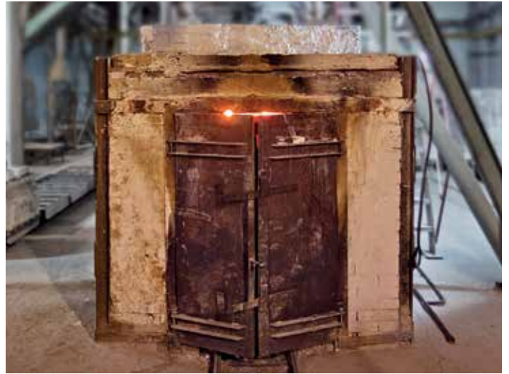
Оборудование для приготовления шликера: барабанная мельница (слева); печь для синтеза керамического материала путем спекания порошка из смеси глинозема с добавками (справа)
