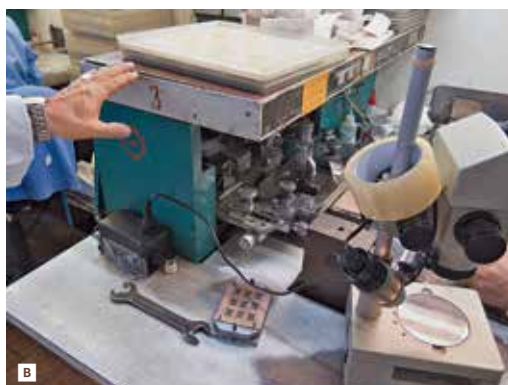
Оборудование участка сырой керамики, на котором сегодня выпускается основная масса корпусов: А – вырубка отверстий штампом; В – пост металлизации полуавтоматической линии «Ободок-18»; С – установка замоноличивания
