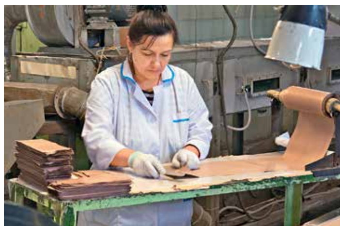
Изготовление карт на старом оборудовании: линия литья керамической ленты (сверху); процесс нарезки ленты на карты и контроля (снизу)
