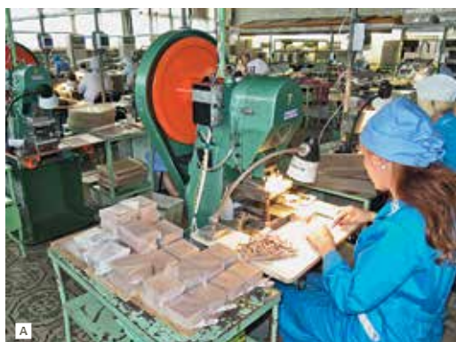
Оборудование участка сырой керамики, на котором сегодня выпускается основная масса корпусов: А – вырубка отверстий штампом; В – пост металлизации полуавтоматической линии «Ободок-18»; С – установка замоноличивания
