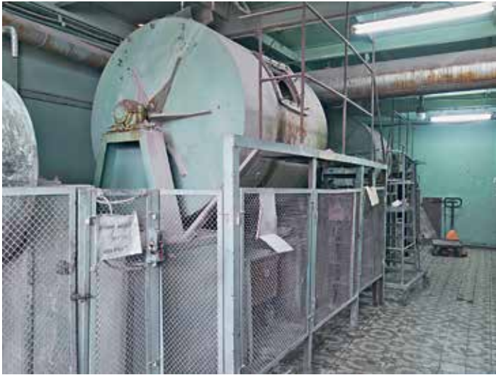
Оборудование для приготовления шликера: барабанная мельница (слева); печь для синтеза керамического материала путем спекания порошка из смеси глинозема с добавками (справа)
