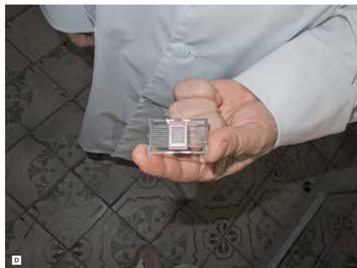
Пайка: A — графитовая групповая оснастка для сборки комплекта основания корпуса перед пайкой; B — сборка деталей корпуса в оснастке; C — конвейерные печи с водородной средой; D — готовый продукт: основание корпуса микросхемы
