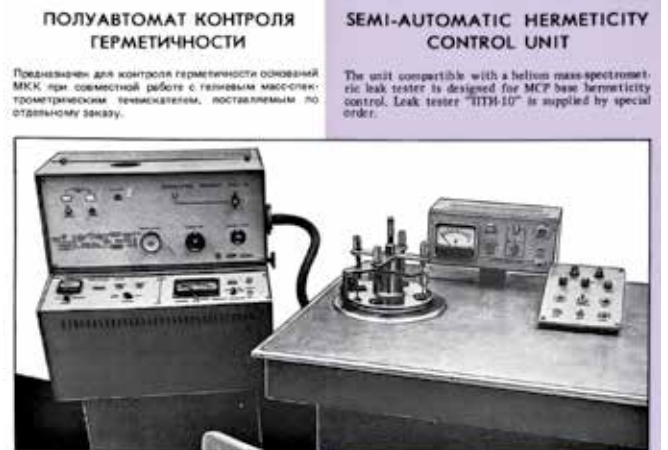
На выходном контроле проверяется 100 % изготовленных оснований корпусов: визуальный контроль (слева); полуавтомат контроля герметичности с гелиевым течеискателем (справа)
