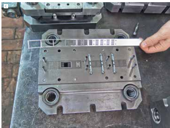
Решение проблемы высокоточных штампов для серийной продукции: A, B — электроискровые проволочно-вырезные станки Sodick SLC400G и AQ400L; C, D — нижняя и верхняя плиты многопозиционного штампа, изготовленные на этих станках
