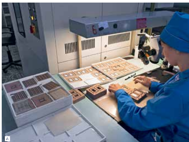
Последние операции перед разделением групповой заготовки: А – рабочее место комплектования пакета карт (идет сборка пакета сдвоенной заготовки корпусов с глубоким колодцем для ФПЗС); В – упаковка пакета карт в герметичную оболочку с откачкой из нее воздуха; С – изостатический пресс КЕКО ILS-66, в котором производится ламинирование (замоноличивание) пакета
