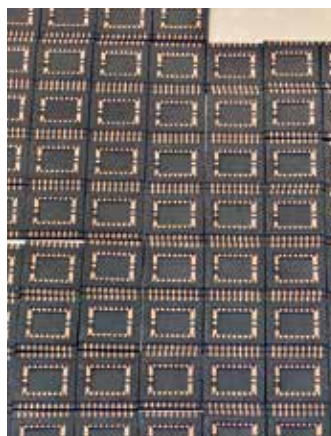
Разделение групповой заготовки: установка резки сырой керамики КЕКО СМ-15 (слева); разделенные заготовки корпусов (справа)
