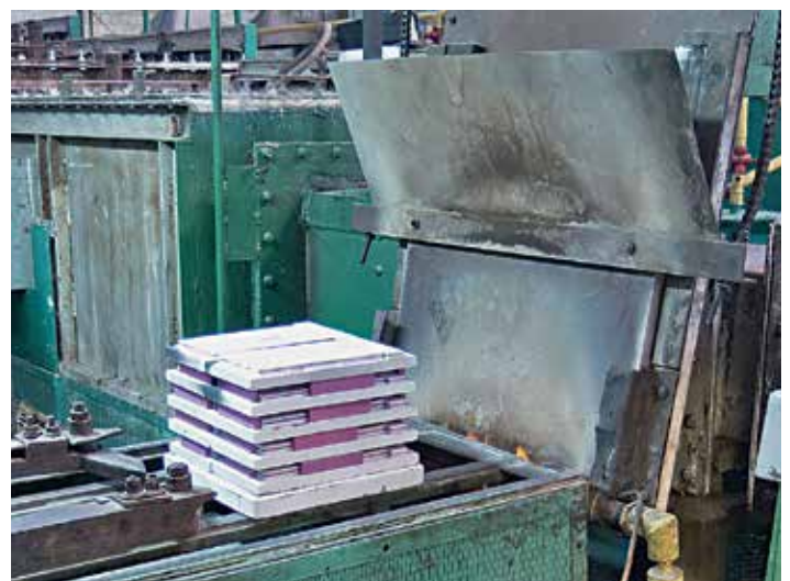
Обжиг: подготовка «этажерки» с заготовками корпусов (сверху); загрузка в азотноводородную печь (снизу)
