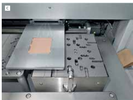
Работа установки РМ-8S: A – манипулятор захватывает карту; B – карта на центровочном столике; C – рама носителя надвинута на отцентрованную карту; D – карта в позиции пробивки – под пуансонами; E – карта с пробитыми колодцами в приемной cassette
