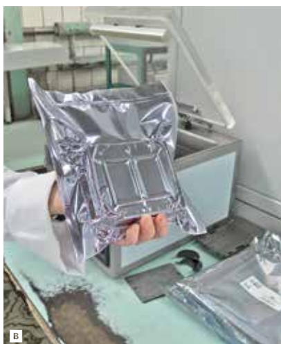
Последние операции перед разделением групповой заготовки: А – рабочее место комплектования пакета карт (идет сборка пакета сдвоенной заготовки корпусов с глубоким колодцем для ФПЗС); В – упаковка пакета карт в герметичную оболочку с откачкой из нее воздуха; С – изостатический пресс КЕКО ILS-66, в котором производится ламинирование (замоноличивание) пакета
