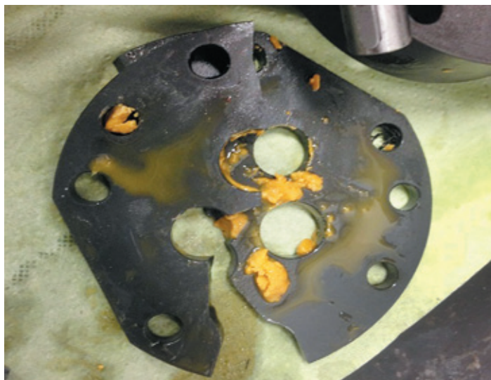
Сломанная деталь насоса. Наполнитель заблокировал насос, в результате чего нагретая стальная пластина корпуса лопнула
