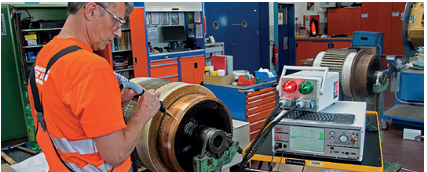
Проверка якоря на межвитковые замыкания импульсным тестом на установке Schleich MTC2
