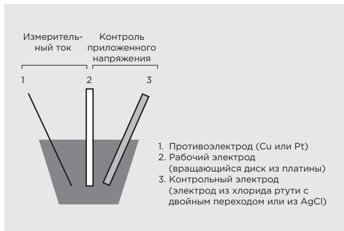
2 Осаждение меди из кислого электролита: метод получения поляризационной кривой – трехэлектродная ячейка
