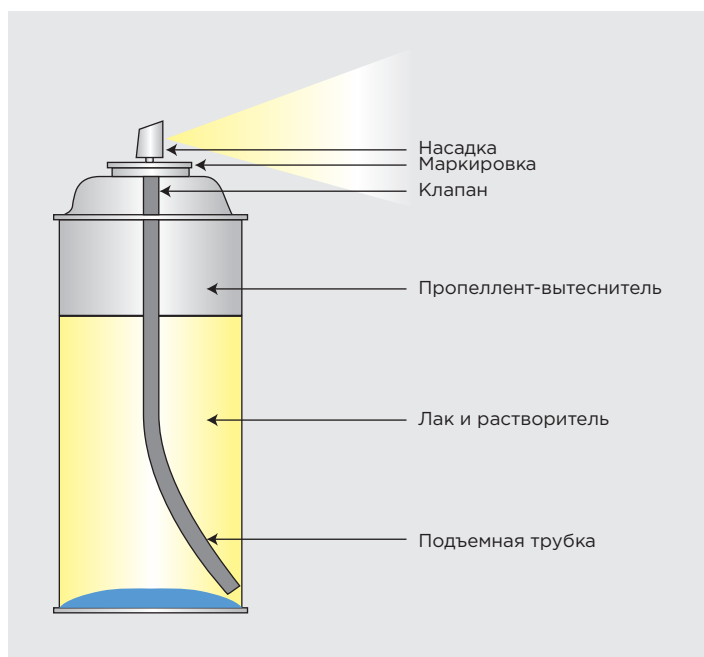
Конструкция аэрозольного баллона
