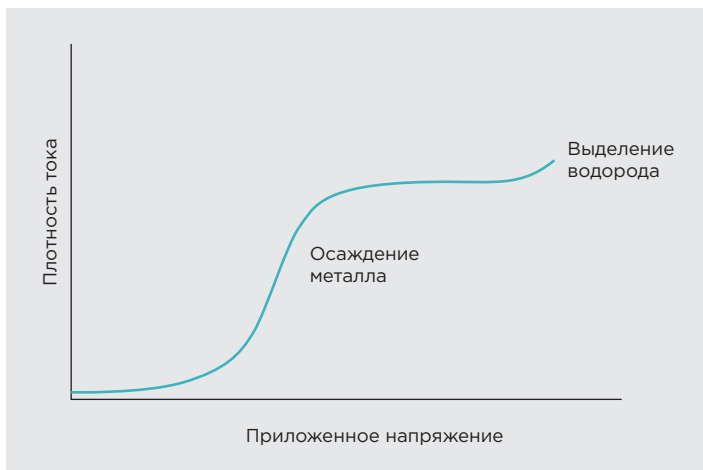
1 Осаждение меди из кислого электролита: кривая поляризации катода
