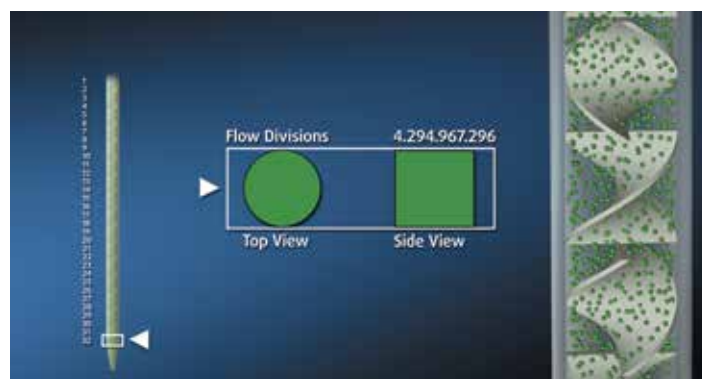
6 Статический миксер трубчатого типа. А начало процесса смешивания компонентов; В финальная стадия смешивания до гомогенного состояния
