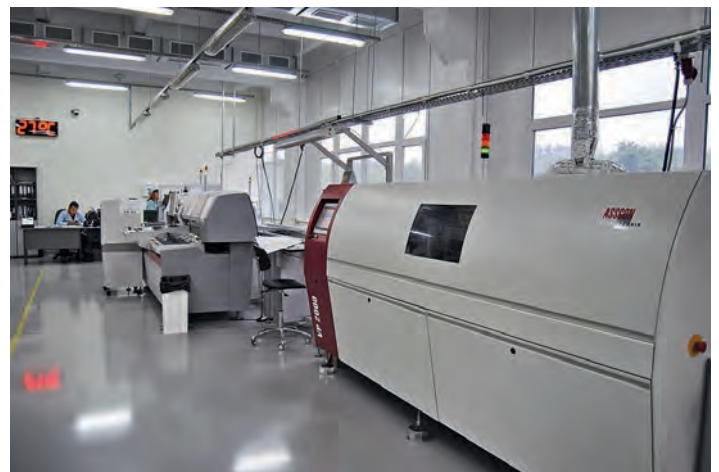
Линия с каплеустройным принтером и установщиком компании MYDATA, вид со стороны печи оплавления
