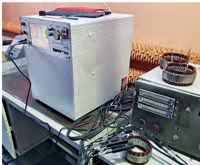
5 МТС2-6кВ с опцией тестирования прочности изоляции
