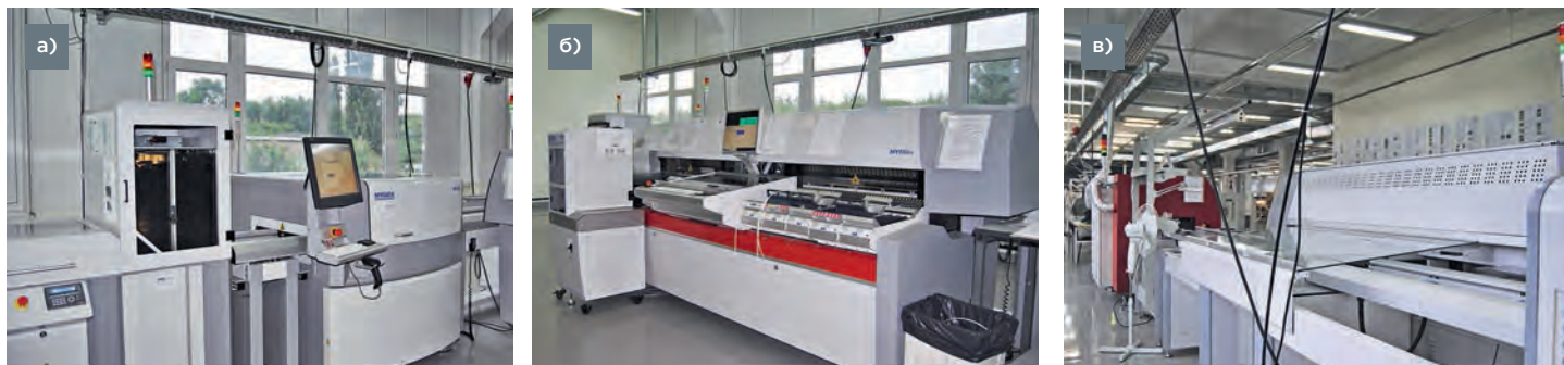
Вторая линия автоматической сборки: а – загрузчик и каплеструйный принтер MY500; б – сборочный автомат MY100DX с боковым загрузчиком из поддонов; в – конвейер с тыльной стороны сборочного автомата
