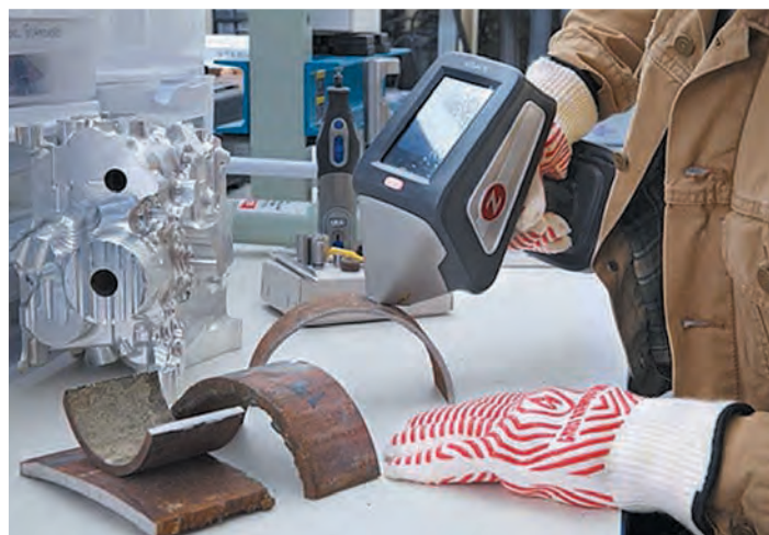
8 Анализ стальных образцов
