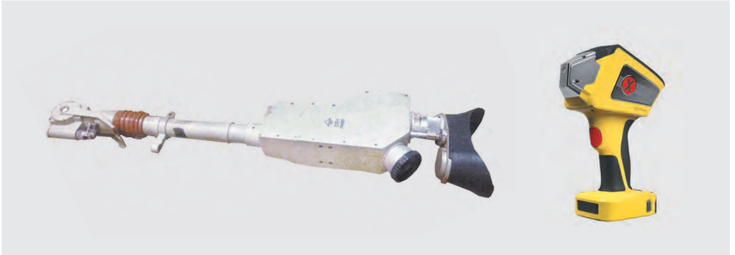
Стилоскоп 30-х годов прошлого столетия и современный РФА анализатор металлов и сплавов SciAps X300 Turbo
