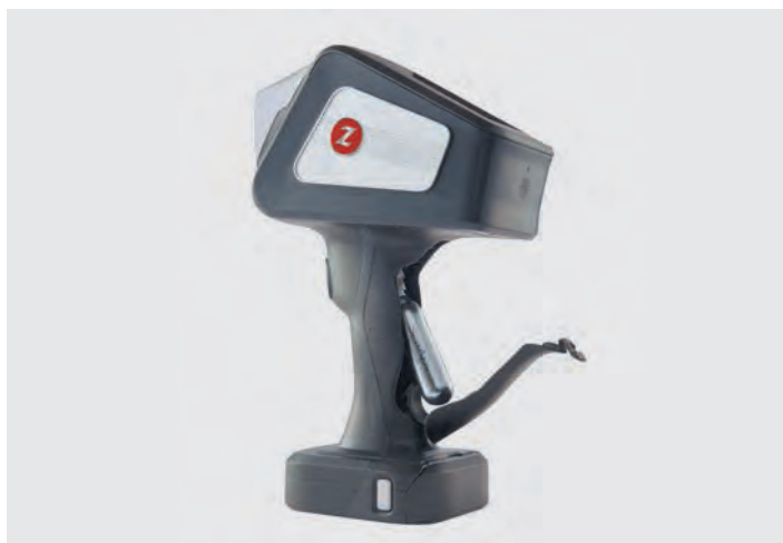
7 Установка баллона с аргоном в спектрометр Z
