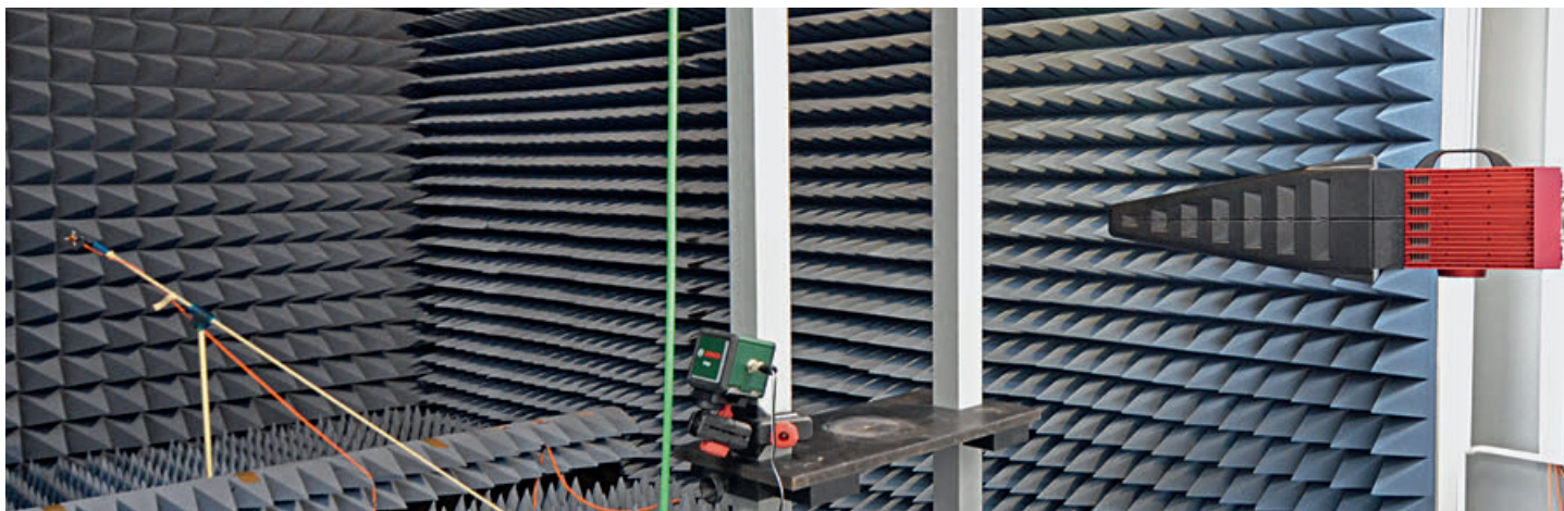
Установка при измерении методом симметрии относительно оси вращения
