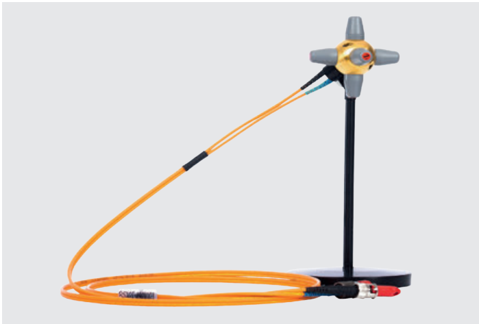
6 Положение датчика напряженности поля при измерении методом вращения в горизонтальной плоскости
