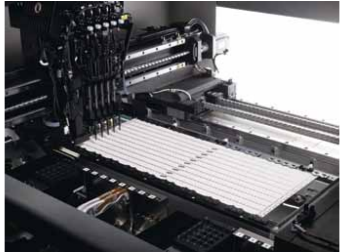
Рис. 10 Автомат SLM 110 с одним порталом, устанавливающий светодиоды на крупную печатную плату
