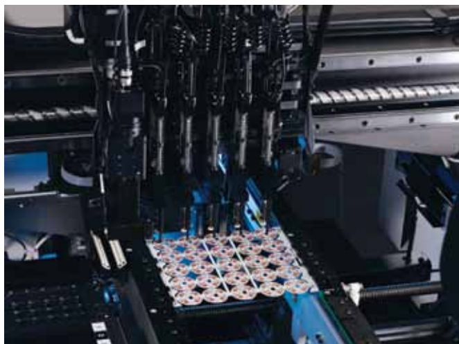
Рис. 13 Автомат SLM110 одним движением устанавливает пять светодиодов на плату. Шаг между захватами изменяется на ходу, подстраиваясь под шаг диодов на плате
