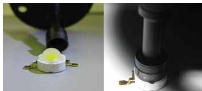
Рис. 4 Светодиод с выпуклой линзой и подходящим вакуумным захватом автомата установки компонентов Fuji NXTII
