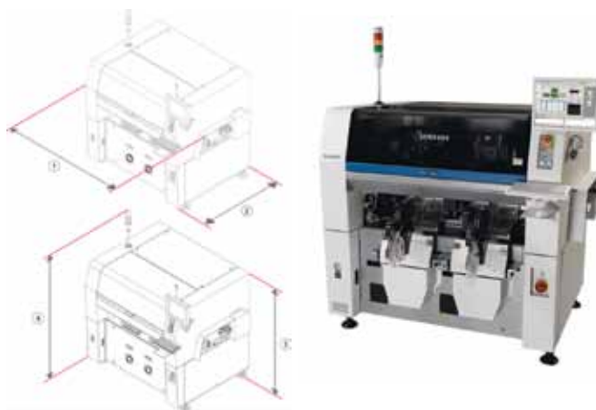
Рис. 17 Эскиз 1 Размеры автомата SLM: 1 – 1650 мм, 2 – 1200 мм, 3 – 1530 мм, 4 – 2090 мм
