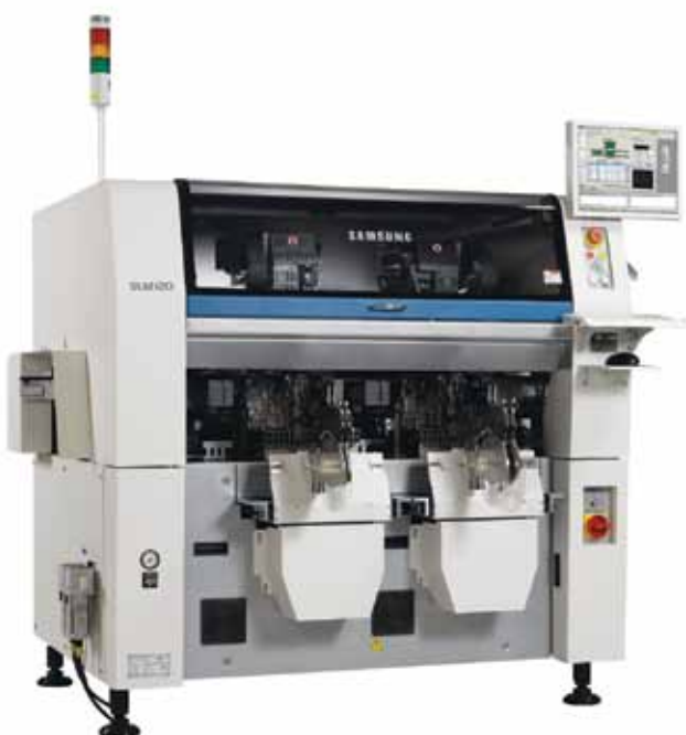
Рис. 9 Специализированный автомат для установки светодиодов SLM120 с двумя установочными порталами
