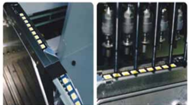
Рис. 12 Специализированный питатель для подачи светодиодов. 1 – рама питателя, 2 – лента с диодами, 3 – направляющая ленты. Момент одновременного захвата пяти светодиодов
