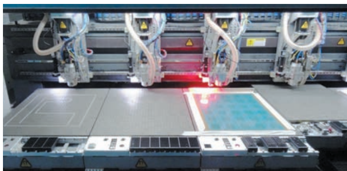
20 Станок в высокотехнологичной комплектации: отдельные столы, видеокмеры на каждом столе, вакуумные столы, фрезерование на глубину
