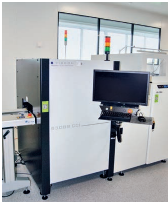
Система автоматической инспекции нанесения покрытия S3088 CCI компании Viscom
