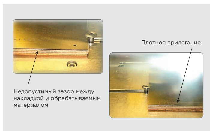
3 Пузырь между заготовкой и накладкой из-за некорректной нарезки
