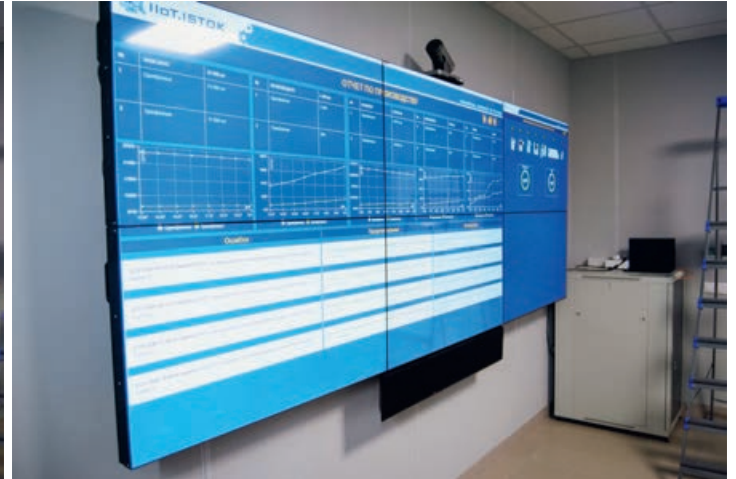
Отображение показателей эффективности использования оборудования и других производственных параметров, собранных системами «Умная линия» и «Умное рабочее место», на экране в диспетчерской
