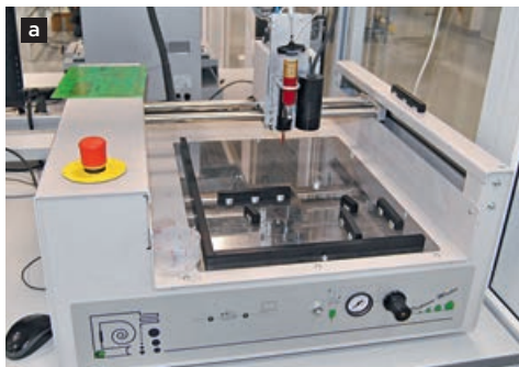
Первый комплект оборудования для поверхностного монтажа: а – система дозирования Dispence Master DD-500 (DIMA, Нидерланды); б – манипулятор Powatec (Essemtec, Швейцария); в – конвекционная печь RO300FC с тремя зонами нагрева и одной зоной охлаждения (Essemtec)
