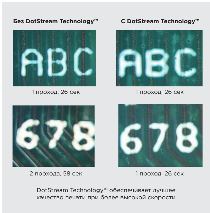
Сравнение качества нанесения с использованием технологии DotStream и без нее
