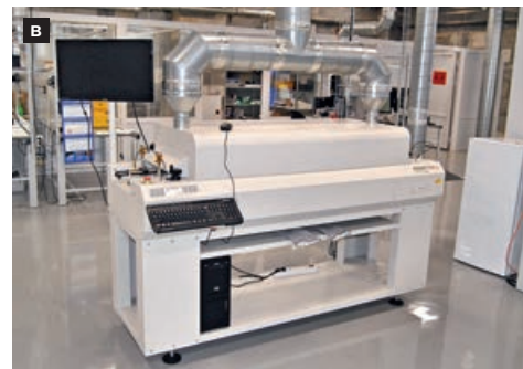
Первый комплект оборудования для поверхностного монтажа: а – система дозирования Dispence Master DD-500 (DIMA, Нидерланды); б – манипулятор Powatec (Essemtec, Швейцария); в – конвекционная печь RO300FC с тремя зонами нагрева и одной зоной охлаждения (Essemtec)
