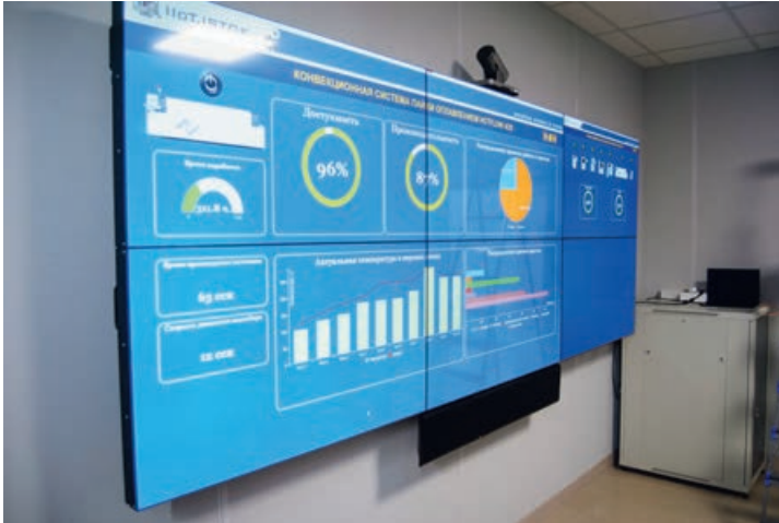
Отображение показателей эффективности использования оборудования и других производственных параметров, собранных системами «Умная линия» и «Умное рабочее место», на экране в диспетчерской
