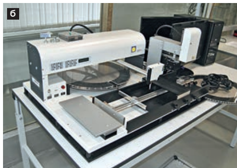
Первый комплект оборудования для поверхностного монтажа: а – система дозирования Dispence Master DD-500 (DIMA, Нидерланды); б – манипулятор Powatec (Essemtec, Швейцария); в – конвекционная печь RO300FC с тремя зонами нагрева и одной зоной охлаждения (Essemtec)
