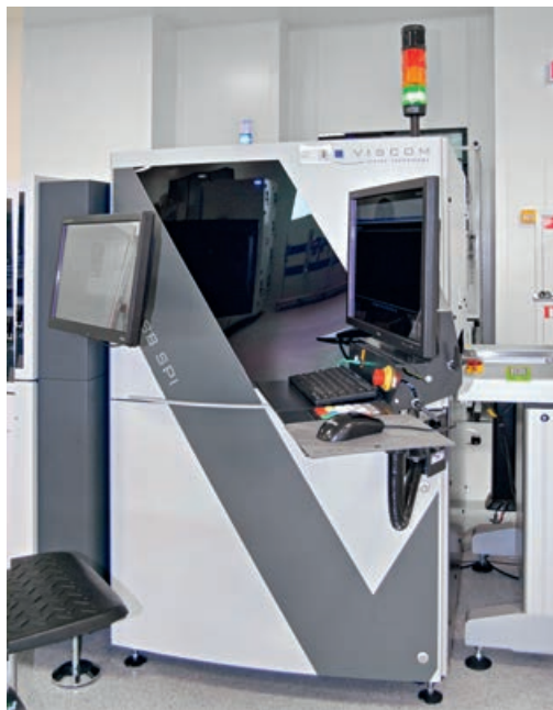
Система автоматической инспекции нанесения паяльной пасты S3088 SPI компании Viscom
