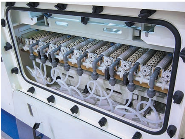
9 Ролики конвейера с встроенными элементами вакуумного отсоса раствора
