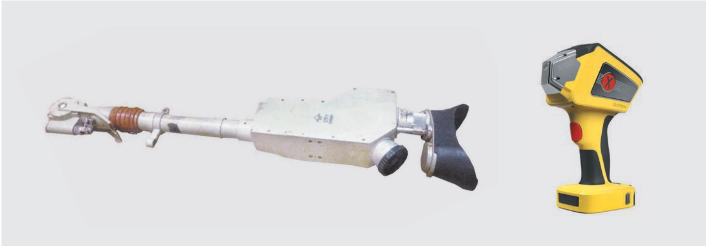
5 Стилоскоп 30-х годов прошлого столетия и современный РФА анализатор металлов и сплавов SciAps X300 Turbo
