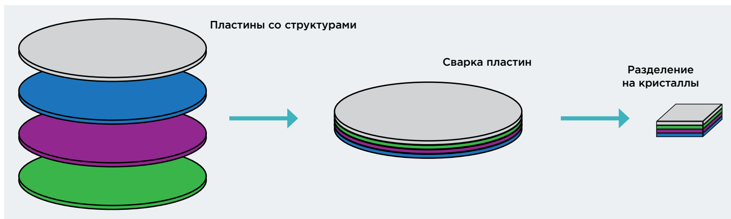
1 Иллюстрация идеи корпусирования на уровне пластины
