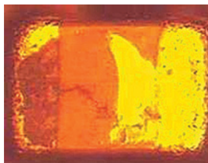
1 Электрохимическая миграция ионов в керамическом конденсаторе
