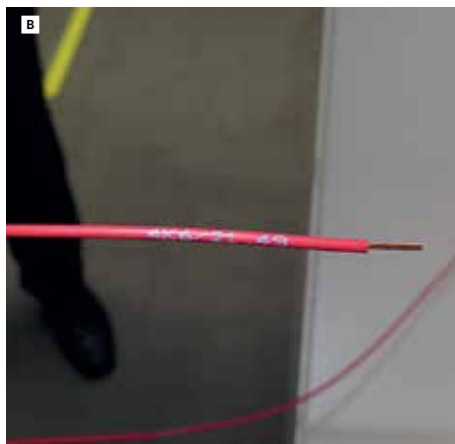
Обработка концов проводов: A – модуль ультразвуковой сварки; B — вывод после УЗ-сварки; C – вывод, армированный наконечником
