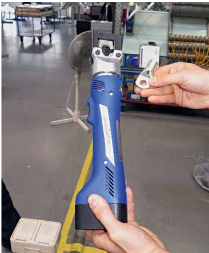
Ручной гидравлический инструмент для опрессовки наконечников. Имеет вставки для наконечников разного диаметра. В отличие от механических обжимных клещей управляется одной рукой и обеспечивает единообразное контролируемое усилие обжатия
