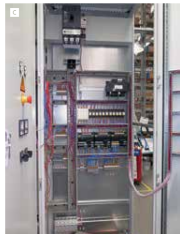
Сборка шкафов управления: A — монтажная плата в шкафу; B — кабельные каналы и компоненты (на монтажной плате — на DIN-рейках, на передней панели — на резьбовых заклепках); C — смонтированный шкаф
