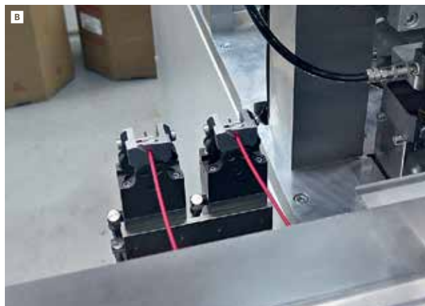
А — принтер маркировки проводов Komax IMS 295 MC; В — перехватывающие захваты (шаттлы); С — ножевой блок
