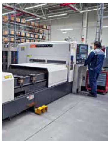
Установка лазерной резки
