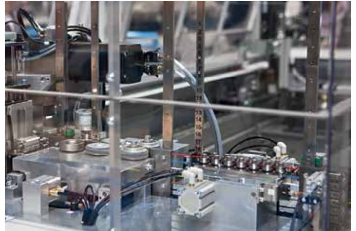
Система подачи проводов и мерной резки Zeta 633. Слева — селектор выбирает один из проводов; справа — шкивы с ремнями протягивают провод через ролики рихтовки; за шкивами — ролик энкодера, отмеряющего заданную длину провода
