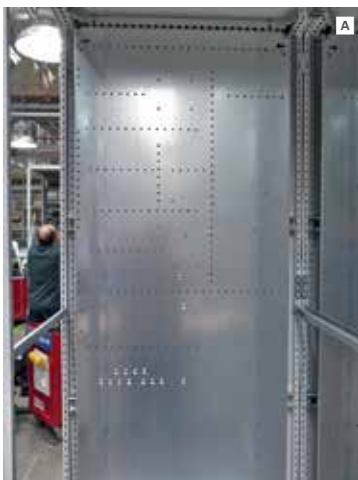
Сборка шкафов управления: A — монтажная плата в шкафу; B — кабельные каналы и компоненты (на монтажной плате — на DIN-рейках, на передней панели — на резьбовых заклепках); C — смонтированный шкаф
