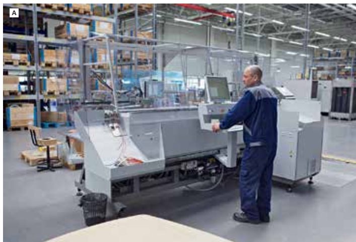
Автоматическая линия Zeta 633: A — с лицевой стороны; B — со стороны системы подачи проводов
