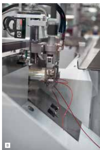
Система бандажирования: A – манипулятор бандажной системы готов захватить изготовленные провода и переместить их к бандажеру; B — изготовление гирлянды; C – готовая гирлянда
