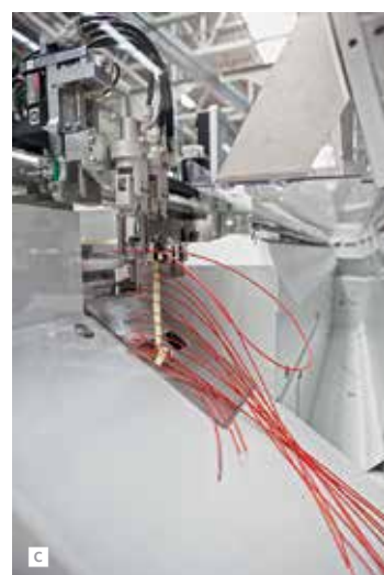
Система бандажирования: A – манипулятор бандажной системы готов захватить изготовленные провода и переместить их к бандажеру; B — изготовление гирлянды; C – готовая гирлянда
