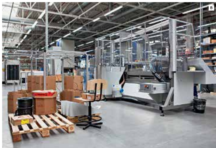
Автоматическая линия Zeta 633: A — с лицевой стороны; B — со стороны системы подачи проводов
