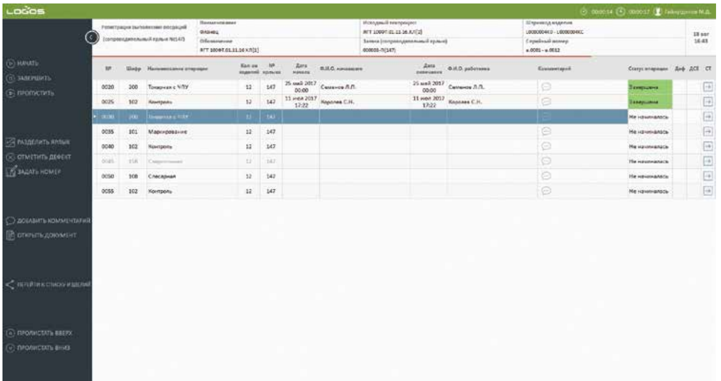
4 Интерфейс терминала коллективного пользования ЦСУП Logos для внесения информации о выполнении технологических операций сотрудниками предприятия
