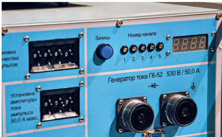
Фрагмент лицевой панели генератора Г6-52. В правой верхней части можно видеть линейку индикаторов, отображающих номер изделия, с которым в данный момент работает прибор
