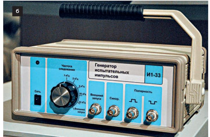
Разработано по собственной инициативе: а – измеритель параметров ферритовых сердечников кольцевой формы Ш1-23; б – генератор испытательных импульсов ИИ-33
