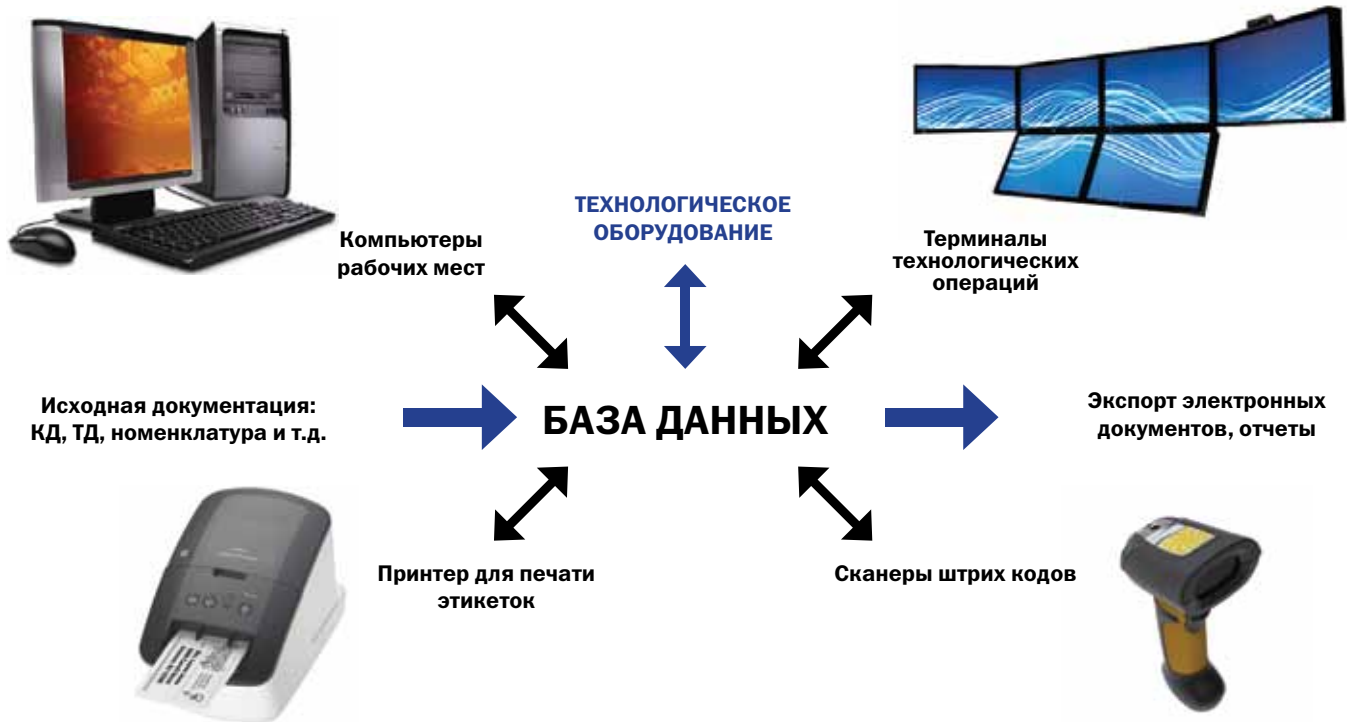
Рис. 1 Общая структура системы прослеживаемости производства изделий электроники
