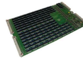
Коммутационные платы У_M64A20 2000 VDC x 1500 VAC x 2A 64 канала (точки)
