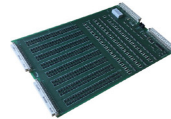
Коммутационные платы У_M192A01 100 VDC x 100 VAC x 100 мА 192 канала (точки)
