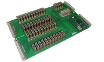
Коммутационные платы У_M22A20 2000 VDC x 1500 VAC x 10A 22 канала (точки)
