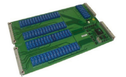
Коммутационные платы У_M32A30 3000 VDC x 2000 VAC/ 2A 32 канала (точки)
