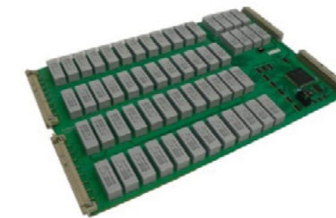
Коммутационные платы У_M24A42 4200 VDC x 3000 VAC x 2A 24 канала (точки)
