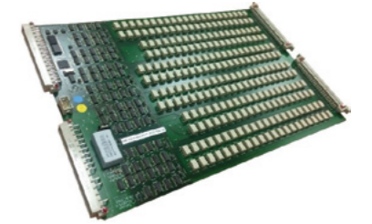
Коммутационные платы У_M128A10 1000 VDC x 750 VAC x 2A 128 каналов (точек)
