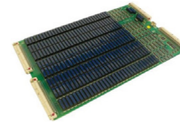
Коммутационные платы У_M128A5 500 VDC x 350 VAC x 2A 128 каналов (точек)
