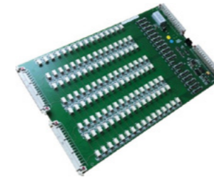
Коммутационные платы У_M64A15 1500 VDC x 1000 VAC x 2A 64 канала (точки)
