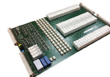
Коммутационные платы У_MS32A15 1500 VDC x 1000 VAC x 2A Тест/ 5A 32 канала (точки)
