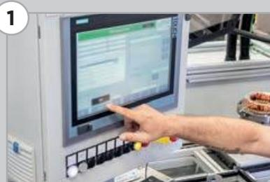
1 Оператору приходит задание на панель управления, и он монтирует соответствующий сердечник на поддон
