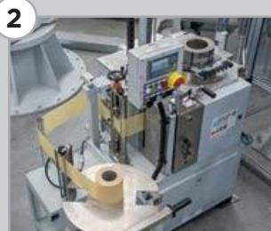
2 Монтаж пазовой изоляции
