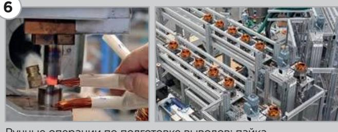
6 Ручные операции по подготовке выводов: пайка наконечников и закрепление выводов в оснастке для последующих операций
