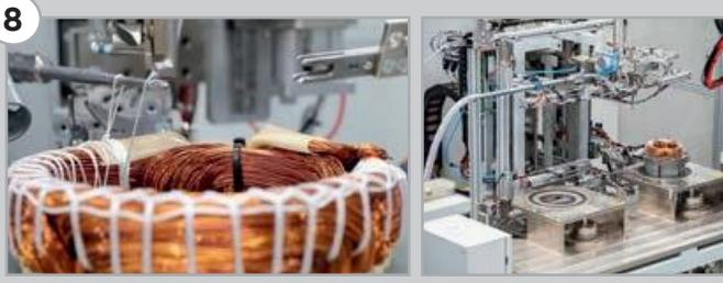
8 Одновременная обвязка лобовых частей с двух сторон
