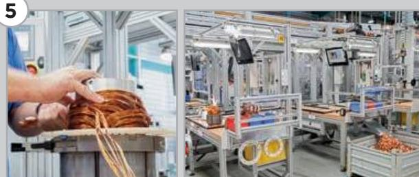
5 Ручные операции по подготовке выводов: распределение, обрезка, изолирование
