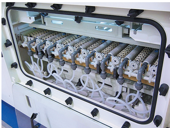
Ролики конвейера с встроенными элементами вакуумного отсоса раствора
