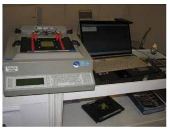
Рис. 1 Тестер моточных изделий AT3600 фирмы Voltech
