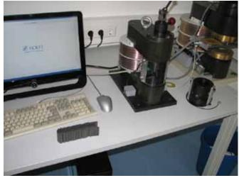
Рис. 6 Оборудование для тестирования магнитных сегментов электродвигателей
