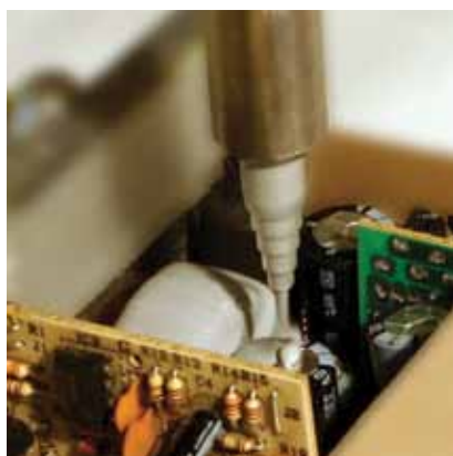
Рис. 1 Процесс заливки электронного блока двухкомпонентным компаундом
