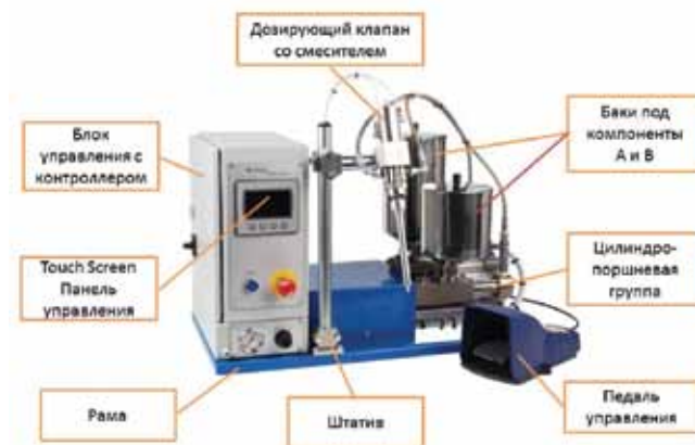
Рис. 5 Система дозирования двухкомпонентных материалов Fisnar Liquid Control LC120FR
