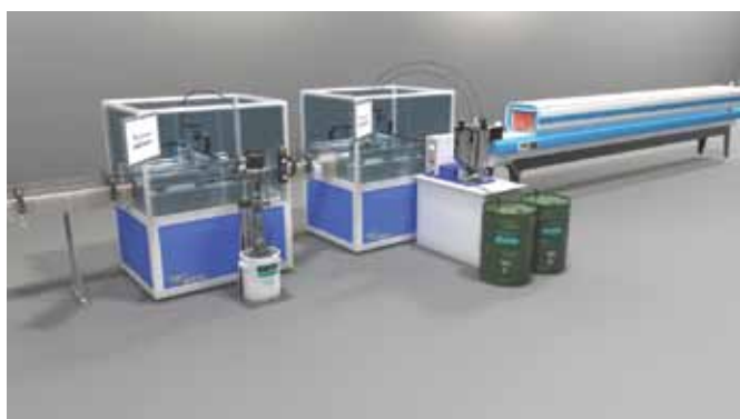
Рис. 3 Автоматизированный участок применения двухкомпонентных клеев, герметиков и компаундов
