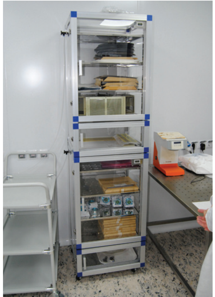
Один из шкафов сухого хранения, в которых хранятся исходные материалы, заготовки и незавершенные изделия
