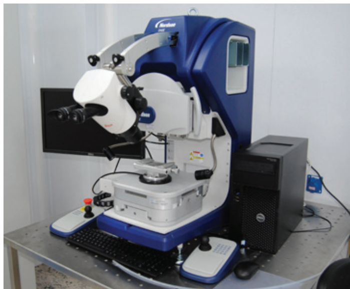
Установка испытаний на прочность 4000 Optima Bondtester
