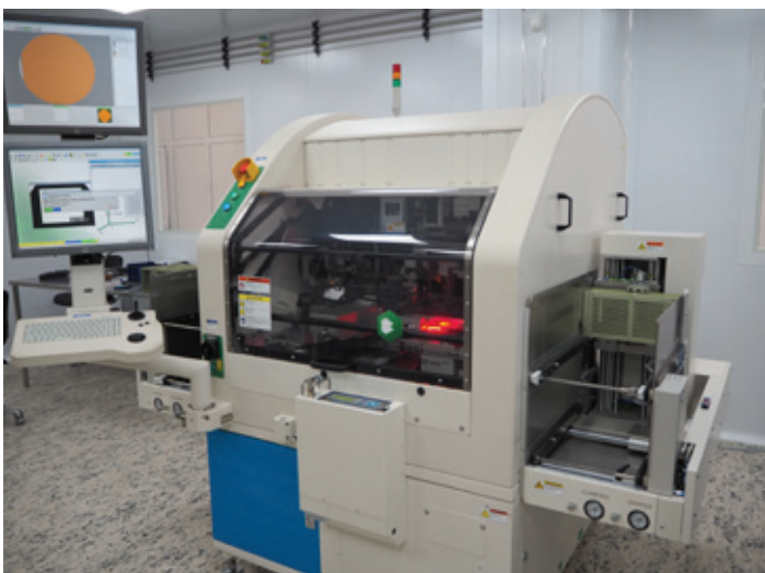
Автоматическая система установки кристаллов Datacon 2200 evo plus
