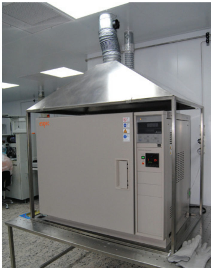
Шкаф сушки от компании Espres, в котором производится отверждение клея
