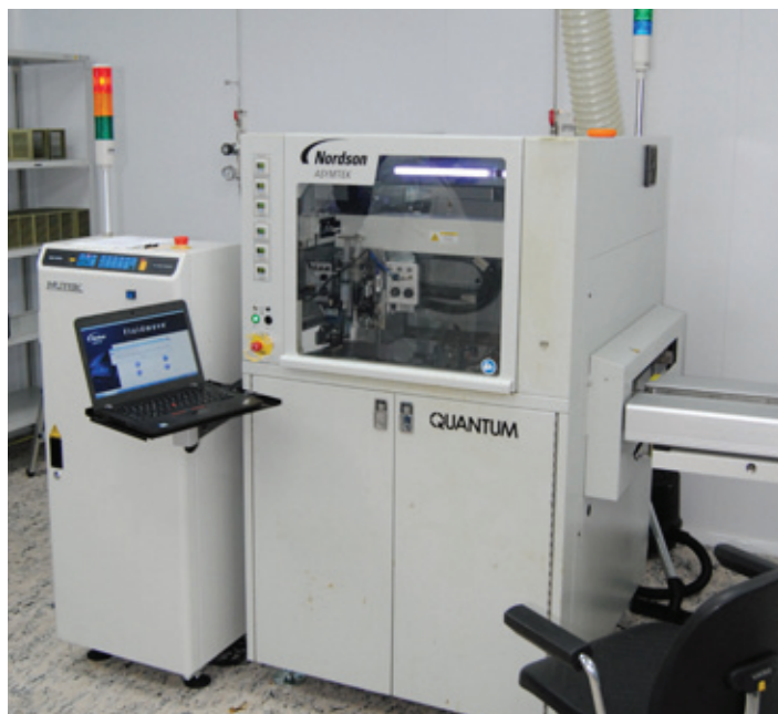
Автоматическая установка нанесения материалов Quantum
