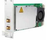
200 нс и 100 секунд. Длительность и повторяемость импульсов можно настроить отдельно, используя гибкие настройки импульсной модуляции. Генератор радиочастотных сигналов RGN0600B имеет 2 х разъема SMA, 1 х SMA для частот от 9 к $\Gamma$ ц до 230 М $\Gamma$ ц (нижний диапазон) и 1 х SMA для частот от 80 М $\Gamma$ ц до 6  $\Gamma$ Г $\Gamma$ ц.
