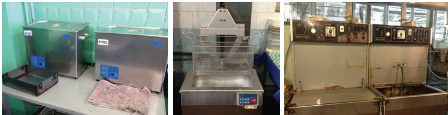
Очистка деталей в ультразвуковых ваннах на действующих производствах
