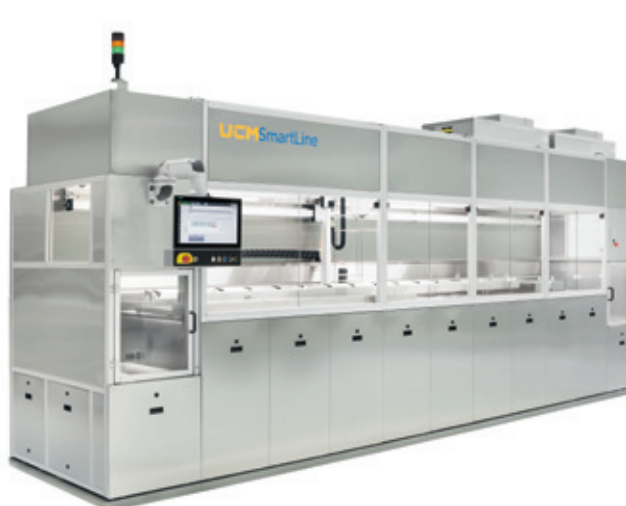
UCMSmartLine – модульная система ультразвуковой прецизионной очистки
