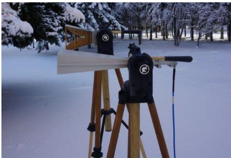
Фото 1. Антенный измерительный комплект на диэлектрических штативах ШАД-01
